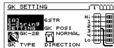
2. Pulse el botón [PAGE ▶] y gire el dial VALUE para introducir la longitud de la escala del bajo para que se ajuste a la del GK-KIT-BG.
