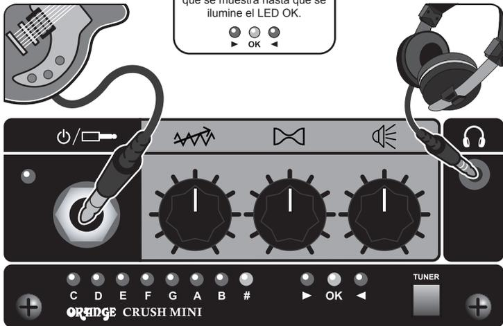
**GAIN:** Ajusta el nivel de ganancia. Se puede lograr una variedad de tonos, desde limpio (ajuste bajo) a distorsión pesada (ajustes más altos) y en cualquier punto intermedio.
