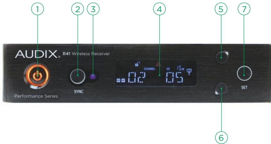
**1** Interruptor de poder. Presione para encendido instantáneo. Presione y sostenga por 3 segundos para apagar el sistema.
