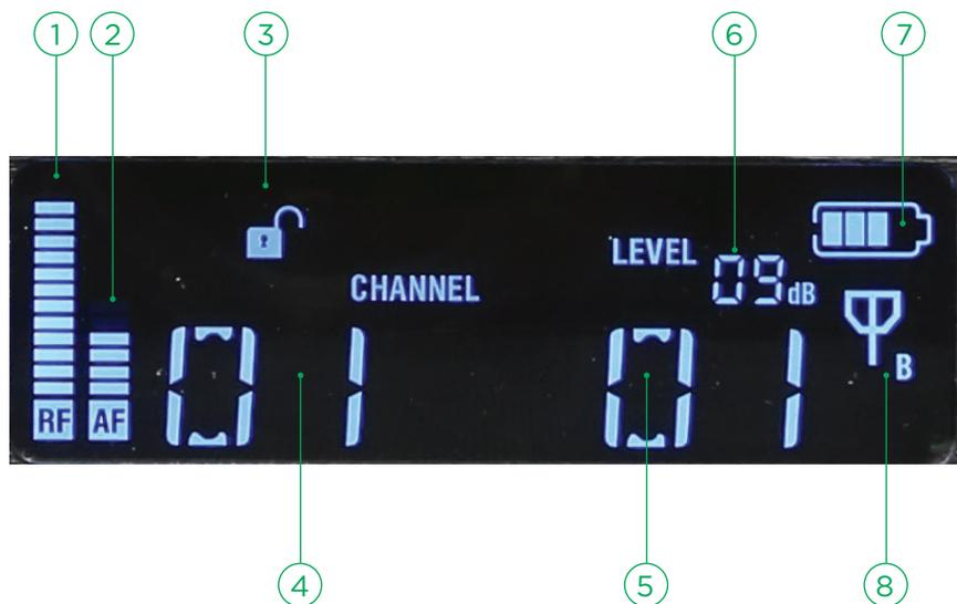
**1** RF(Radio Frecuencia). Muestra la fuerza de la señal RF
