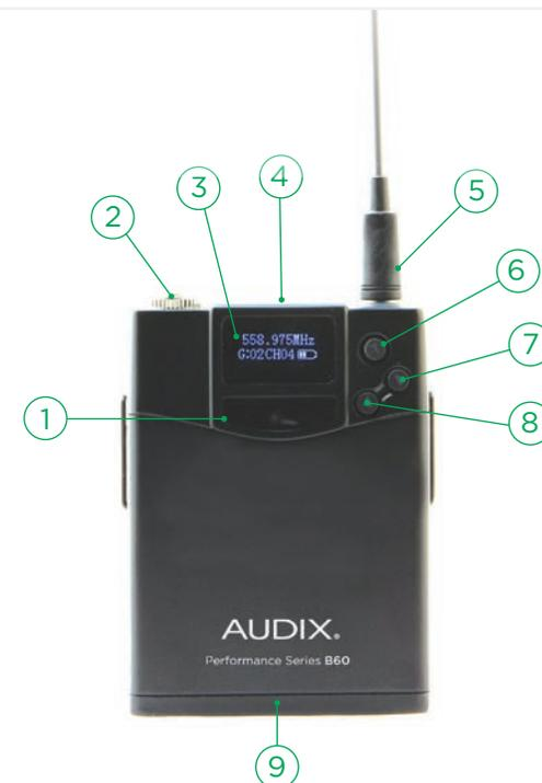
**1** Panel infrarrojo. Apunte hacia el botón de sincronizado sobre el receptor cuando enlace el transmisor al receptor.
