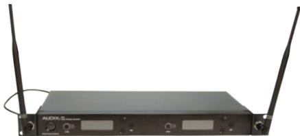
Después de que el RMT 42 está unido al receptor, siga las instrucciones para el RMT 4161 en la página anterior para unir los conectores BNC y el montaje frontal de las antenas.
