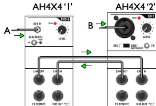
**TIP:** Cuando utilice el enchufe de entrada de enlace, el modo de "reposo" se desactivará temporalmente para que el esclavo no se apague innecesariamente. (El modo de reposo monitorea los canales de entrada).
