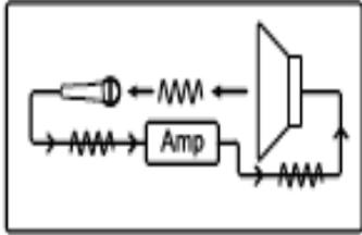
La retroalimentación del audio es causada cuando un “loop” o bucle ocurre entre el micrófono o la pastilla de una guitarra y el amplificador. Comúnmente causada por apuntar un micrófono a la bocina o simplemente porque se colocan muy cerca. El resultado es un chillido poco placentero o un silbido. El AH4x4 está equipado para hacer frente a esto.
