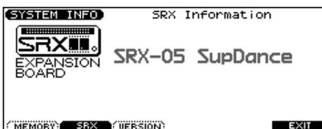
\* Si no se muestra el nombre de la placa, es posible que la unidad no reconozca correctamente la placa. Apague la unidad y vuelva a instalar la Placa de Ampliación de Ondas .
